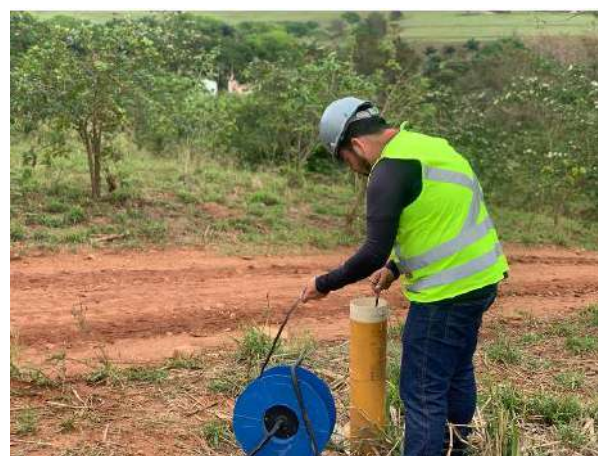
Foto 4 – Leitura de nível d'água no PM-BDP-08. (Data: 27/09/2022).
