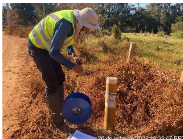
Foto 2 – Leitura de nível d'água no PM-BDP-08. (Data: 26/07/2022).
