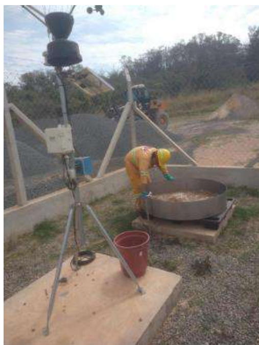
Foto 7 – Colaborador realizando a Limpeza do reservatório de água da EMA. (Data: 21/09/2022).
