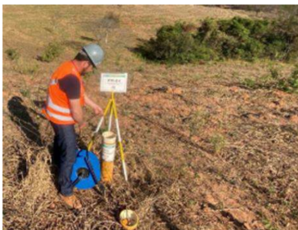
Foto 3 – Leitura de nível d'água no PM-BDP-08. (Data: 27/08/2022).
